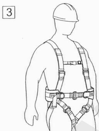
**Zapojení přední spojovací přezky**
